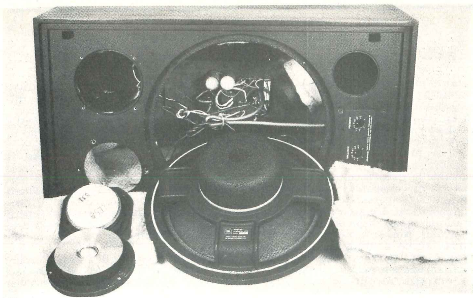
I magnifici trasduttori della « Horizon ». Il woofer è il 122 A da 30 cm, il midrange a cono è l'LE-5 ed il tweeter a cupola è un modello nuovo: lo 066.
